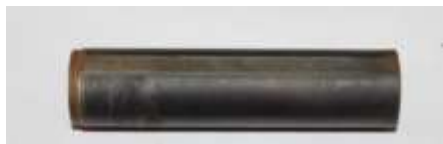
Рисунок 4.3 - Загартовані зразки з протравленими лисками
