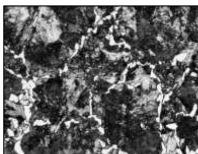
Рисунок 3.2 – Мікроструктура головки рейки в гарячекатаному стані в районі точки 1 по ДСТУ 4344: 2004 (точка RS по ДСТУ EN 13674-1:2018)
