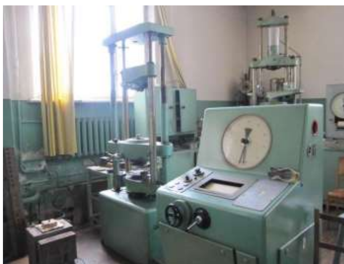
Рисунок 2.4 – Загальний вид випробувальної машини ЦД-40/10
