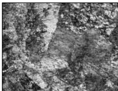
Рисунок 3.3 – Мікроструктура головки рейки в гарячекатаному стані в районі точки 3 по ДСТУ 4344: 2004 (точка 1 по ДСТУ EN 13674-1:2018)
