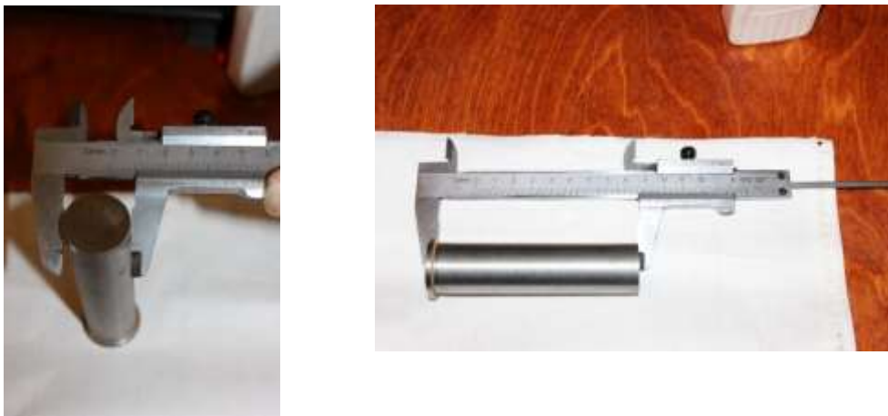
Рисунок 2.7 – Підготовка випробувальних зразків для охолодження з торцю
