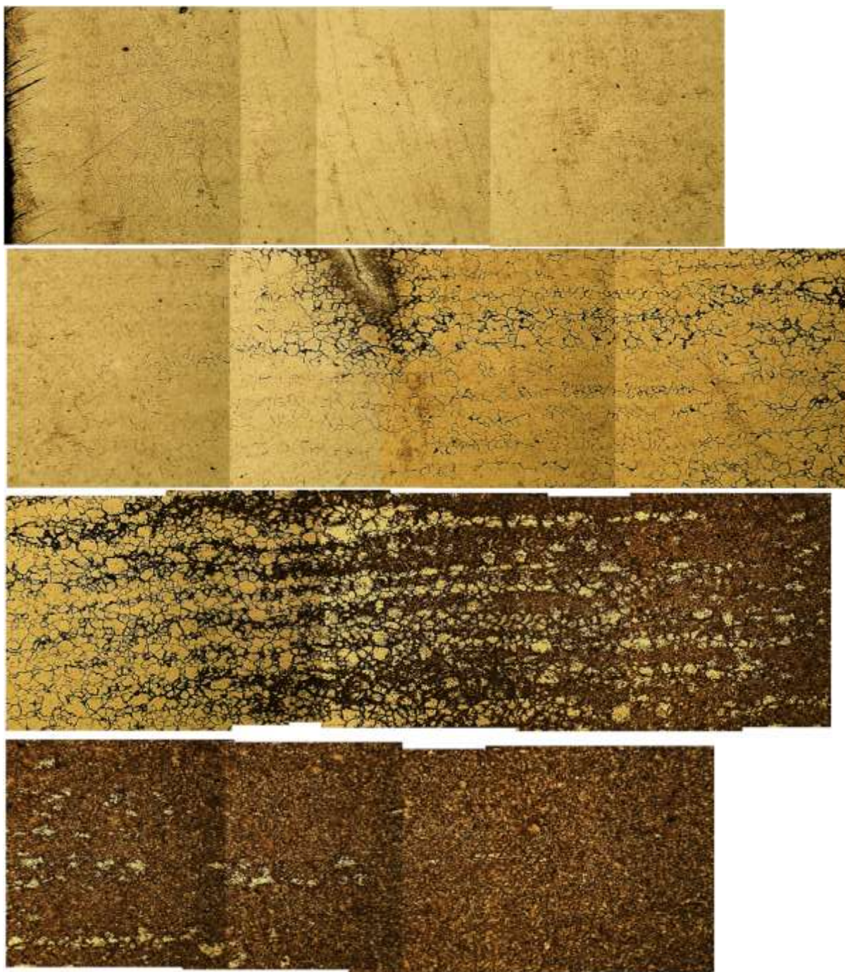
Рисунок 4.5 - Мікроструктура сталі для залізничних рейок K76Ф після торцевого загартування по перерізу вздовж лиски. \times 50
